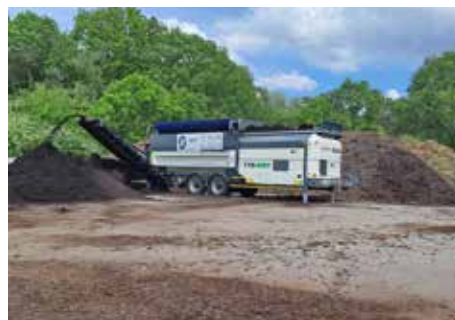
De niet gezeefde fractie komt via de andere transportband op een nieuwe hoop terecht.
